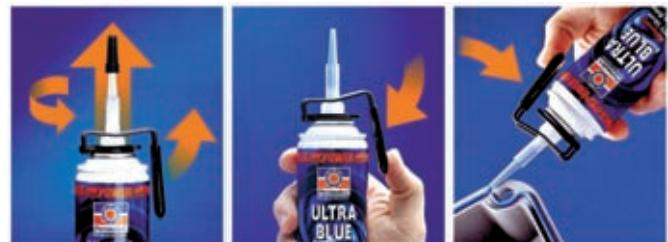
Многие автомеханики сталкиваются со сложностью, а порой и с невозможностью, найти необходимый уплотнитель на снятый с производства иностранный автомобиль или уникальный механизм. Любые прокладки вырубленные из картона, пробки или резины, могут быть с успехом заменены химическими продуктами, с помощью которых можно создать прямо по месту высоконадежные уплотнения требуемой формы, превосходящие своих предшественников практически по всем характеристикам.
